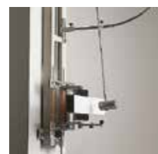
Attrezzatura per prova urti a temperatura ambiente.
