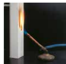
Attrezzatura per prova resistenza alla propagazione della fiamma.
