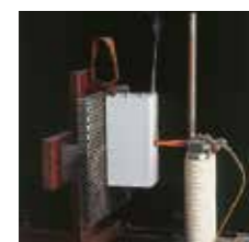
Attrezzatura per prova calore anormale (850°C) GWT.
