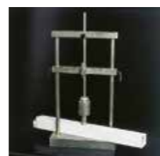
Attrezzatura per prova urti a bassa temperatura.
